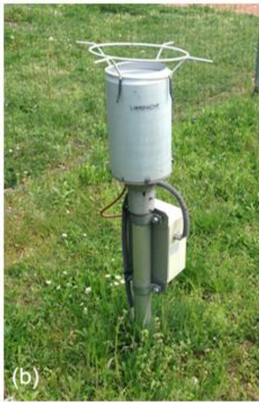
(a) Decagon és (b) Lambrecht gyártmányú csapadékszenzorok az Ifjúság úti campus területén
