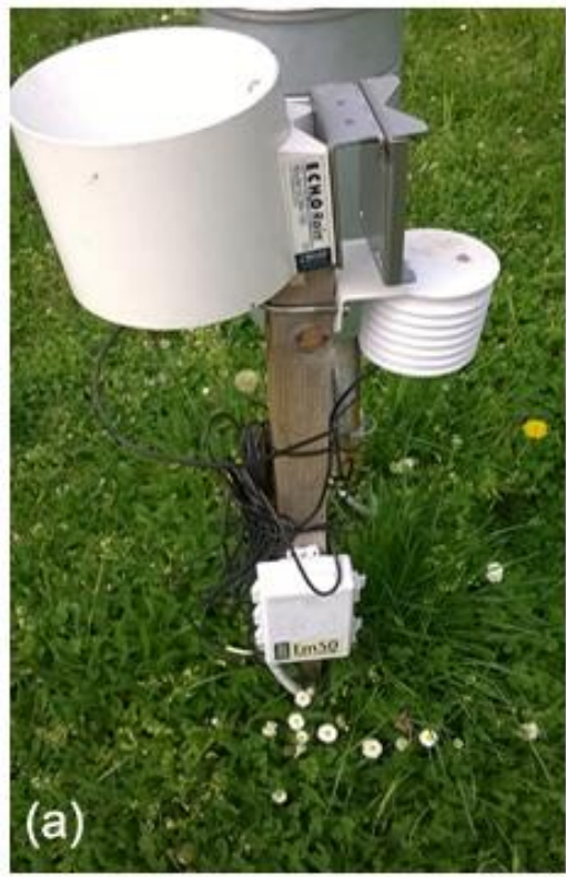
(a) Decagon és (b) Lambrecht gyártmányú csapadékszenzorok az Ifjúság úti campus területén
