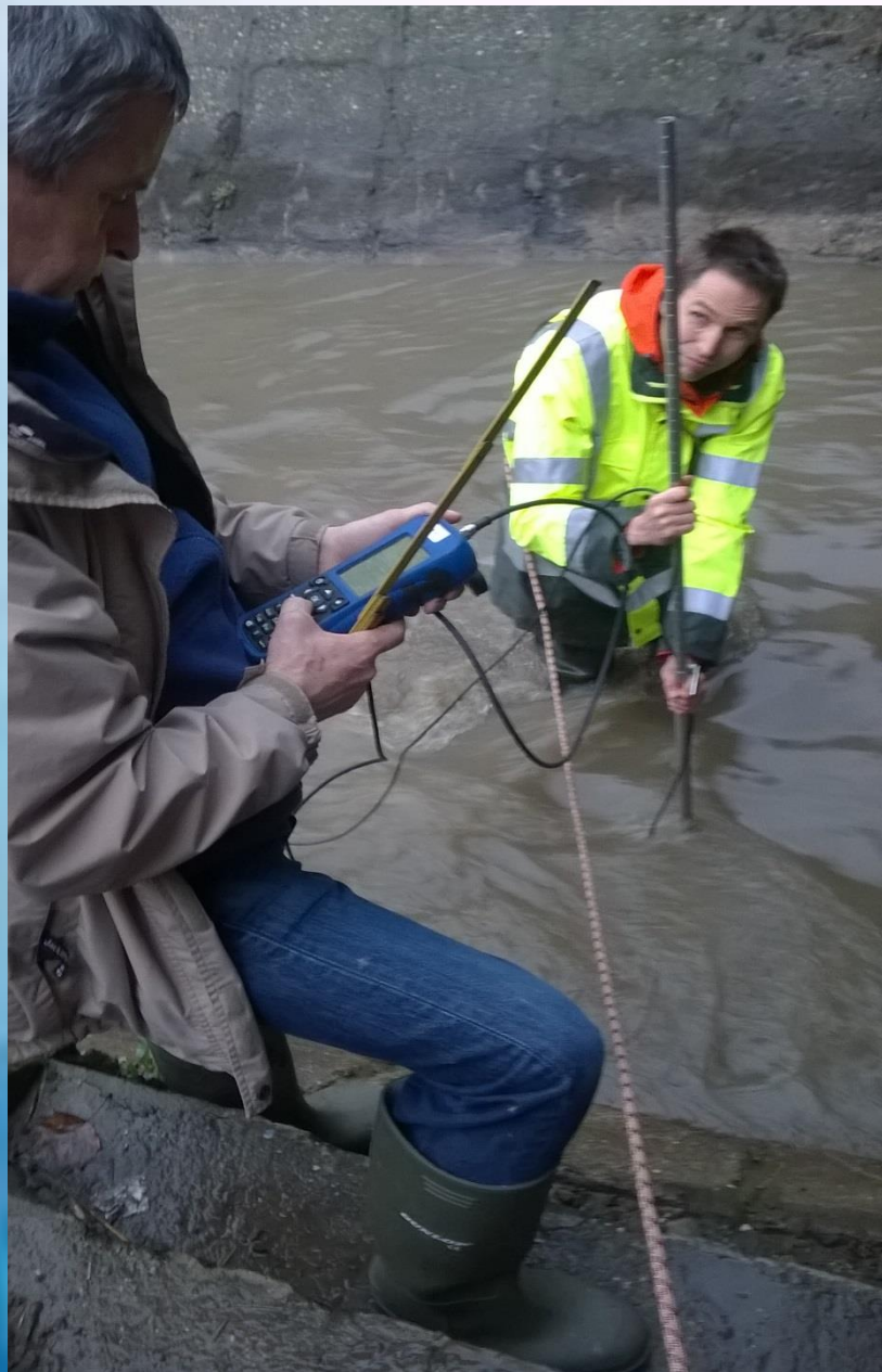
2016.02.15. Vízhozam-mérés. (OTT MF Pro)
