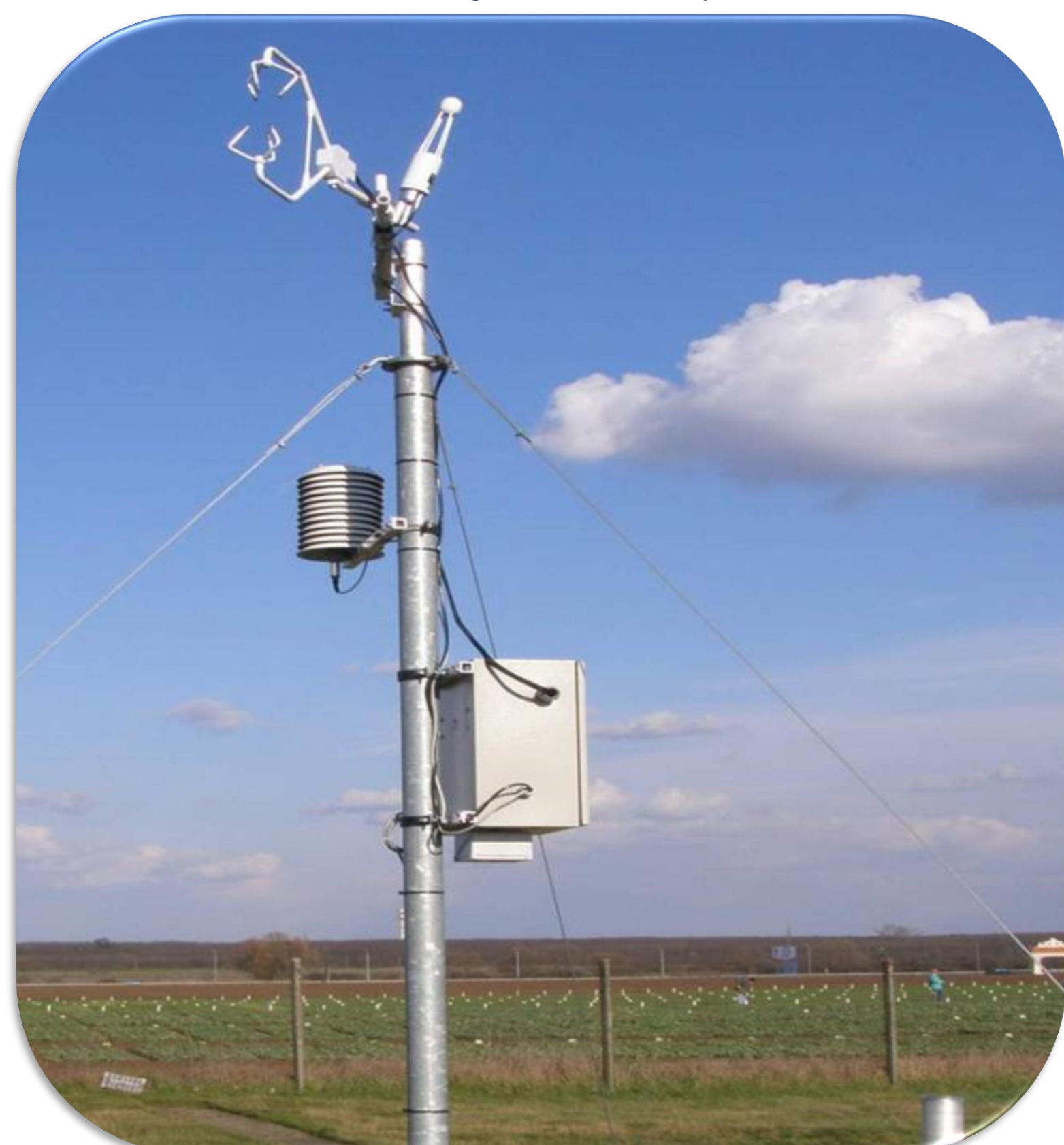
A szenzibilis és a látens hőáram meghatározására szolgáló mérőrendszer
