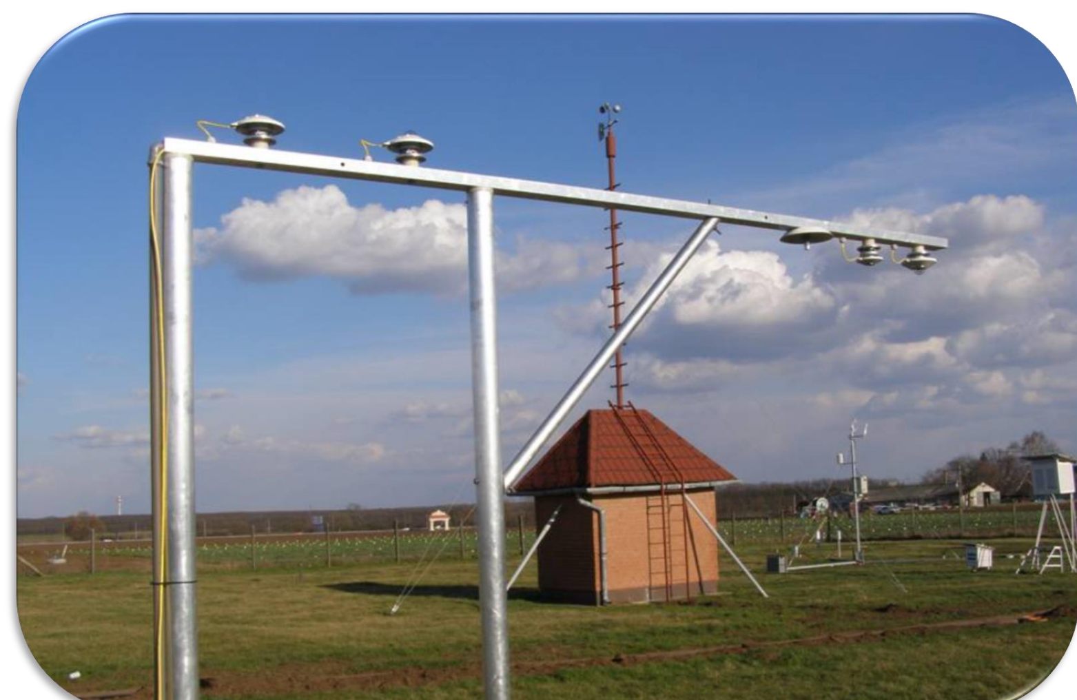
A teljes sugárzási egyenleg komponenseinek mérésére szolgáló mérőállvány
