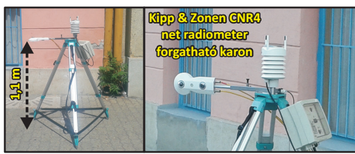
4. ábra: Az átlagos sugárzási hőmérséklet ( T_{mrt} ) pontos meghatározásához használt humán-biometeorológiai mérőműszer
