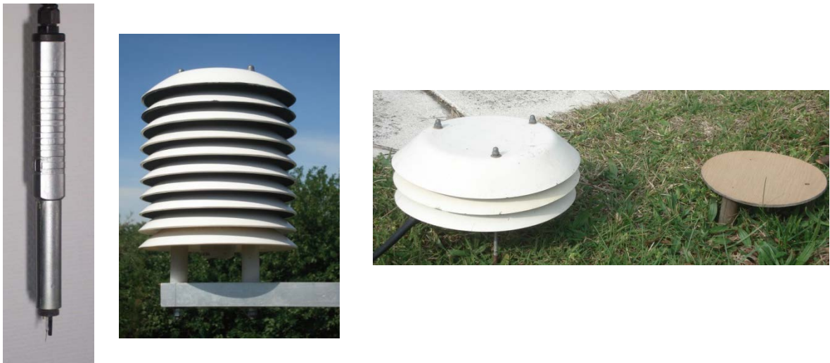
5. ábra: HMP45D típusú kombinált léghőmérséklet, légnedvesség érzékelő és ehhez egy árnyékoló, valamint egy talajközeli hőmérő és egy dérkorong.
