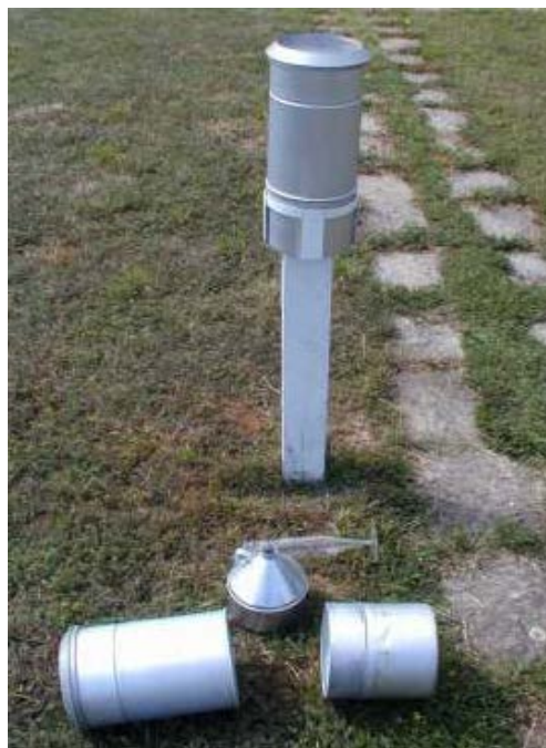
10. ábra: Oláh-Csomor-féle kettősfalú állomási csapadékmérő.
