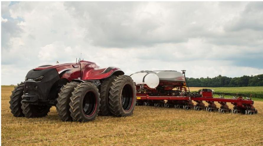
Der Prototyp eines fahrerlosen Traktors von Case © Hersteller
