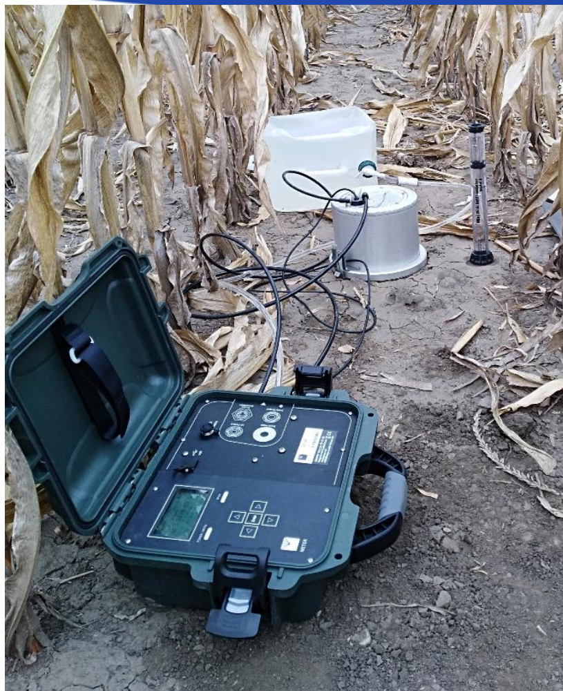
SATURO és a Mini Disk Infiltrómeter mérés közben (Martonvásár)
