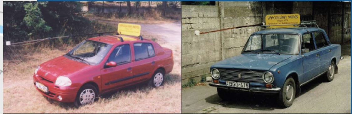
A.2.2. ábra – Mérőautók a rúdra felszerelt hőmérsékleti szenzorral
