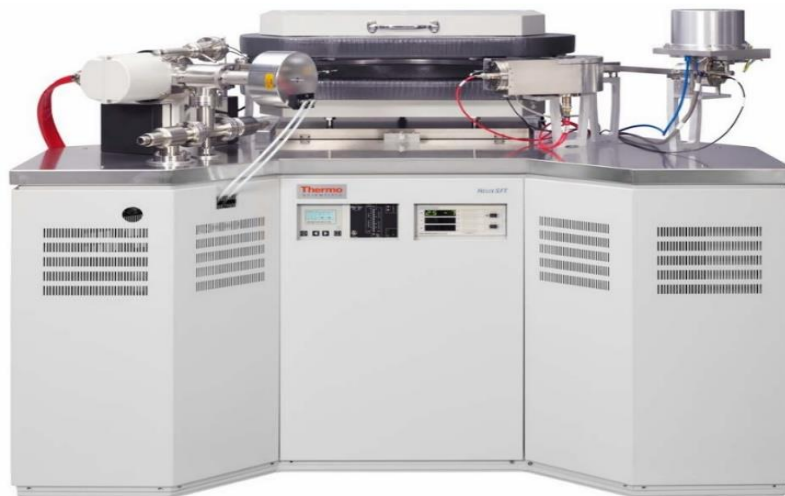
Az Atomki IKER Laboratóriumában található HELIX SFT2 nemesgáz-tömegspektrométer (Isotoptech ZRT)
