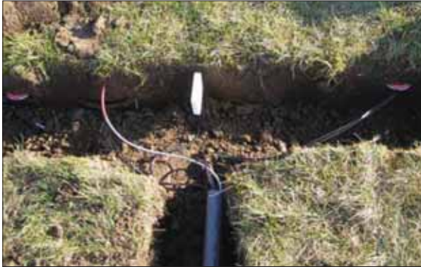
4. kép: Mérőszenzorok a talajnedvesség, talajhőáram és talajhőmérséklet mérésére
