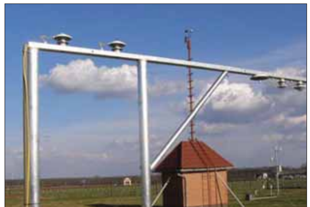
3. kép: A sugárzási egyenleg meghatározására szolgáló mérőrendszer
