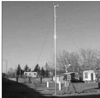
5. ábra A meteorológiai műszergyűjtemény és a frissen üzembe helyezett automata városklíma állomás (a szerző felvételei)
