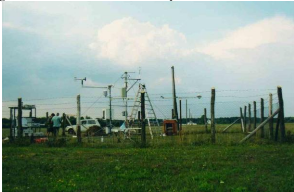
A GRAMINAE EU4 keretprogramban felszín-légkör ammónia kicserélődés meghatározásra. 2000-01-ben ammónia koncentráció-gradiens- és mikrometeorológiai méréseket végeztünk a Hortobágyi Nemzeti Park határa, Püspökladány Farkas-szigeten. Az OMSZ-szal és Erdészeti Tudományos Intézettel (témavezető: Horváth László) közösen a mérések helyszínén többször szerveztünk hallgatói terepgyakorlatot is.
