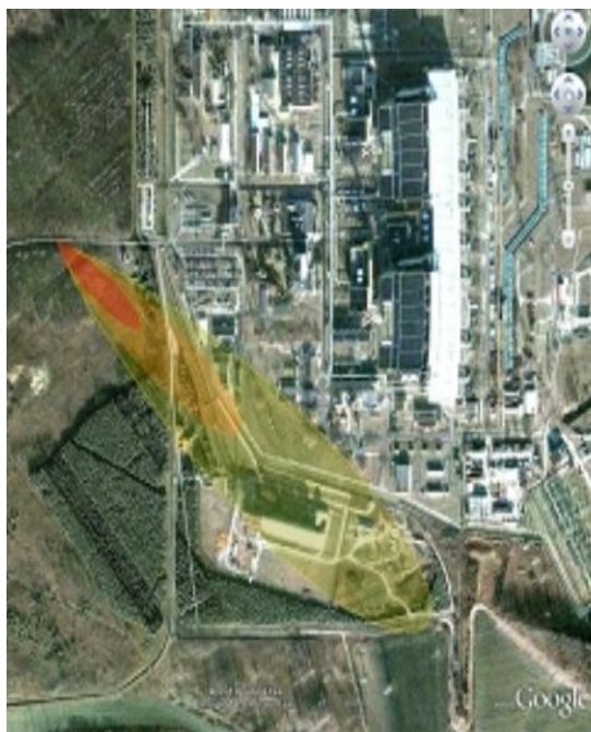
Példa az ALOHA (egyszerű Gauss-típusú modell) alkalmazására: egy feltételezett baleset során 100 kg ammóniát bocsátottunk ki egy perc alatt az atomerőmű bejáratához vezető útszakaszon. Az egyes színek az ammóniára vonatkozó különböző hataérték túllépéseket jelentik.
