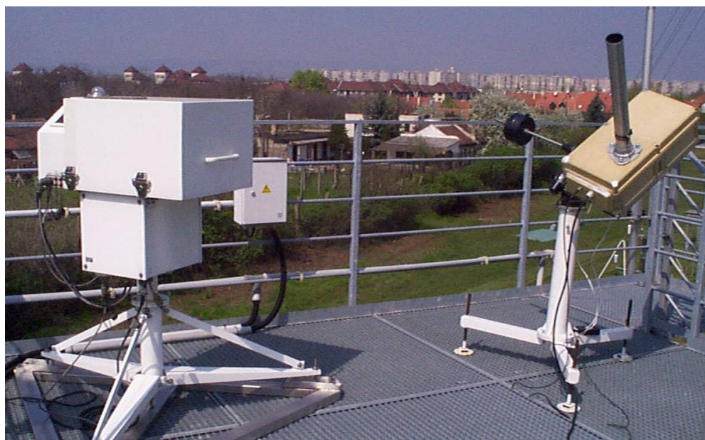
17. ábra: Brewer MKIII spektrofotométer és LI-1800 spektroradiométer
