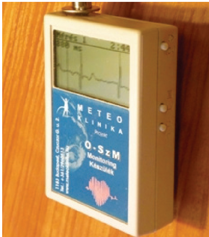
1. ábra: Az ICI Interaktív Zrt. saját fejlesztésű szív működés-monitorozó 3D modellje és legyártott kísérleti sorozatú berendezése
