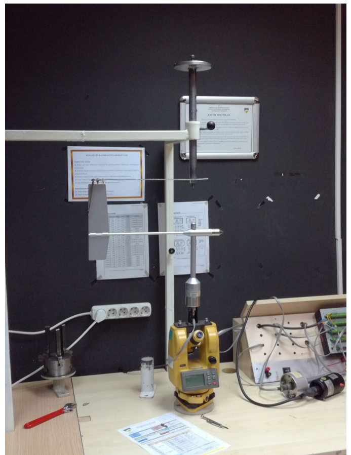
4. ábra: Szélirány érzékelő kalibrálása precíziós teodolittal a TSMS Kalibráló Központjában
