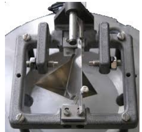
10. ábra: Lambrecht csapadékmérő belseje
