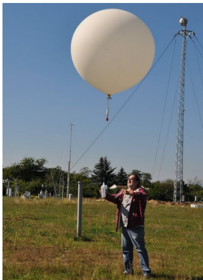
56. ábra: Rádiószonda felbocsátás („dobás”) Pestszentlőrincen
