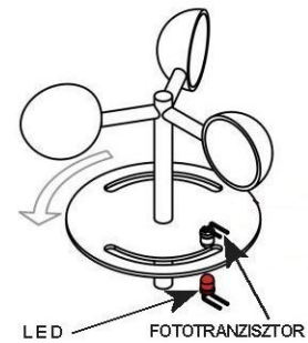
22. ábra: Forgókanalas szélesség mérés elve
