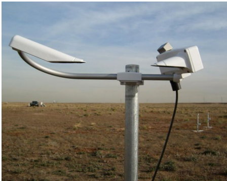
47. ábra: Vaisala PWD22 látástávolságmérő
