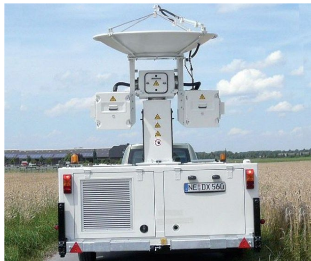
7. ábra: A Pápara telepített Doppler duál-plarizációs SELEX METEOR 60DX mobil mini radar
