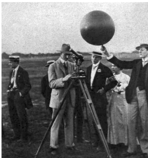
A bécs-budapesti repülőversenyen a felsőbb rétegekben uralkodó szélirány megállapítására szolgáló ballon elbocsátása 1911-ben. (Fotó: Országos Széchényi Könyvtár Digitális Képtárház: http://dka.oszk.hu .)
