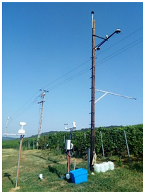
2. ábra: A villányi szőlőültetvények mellett üzemeltetett mikrometeorológiai állomás
