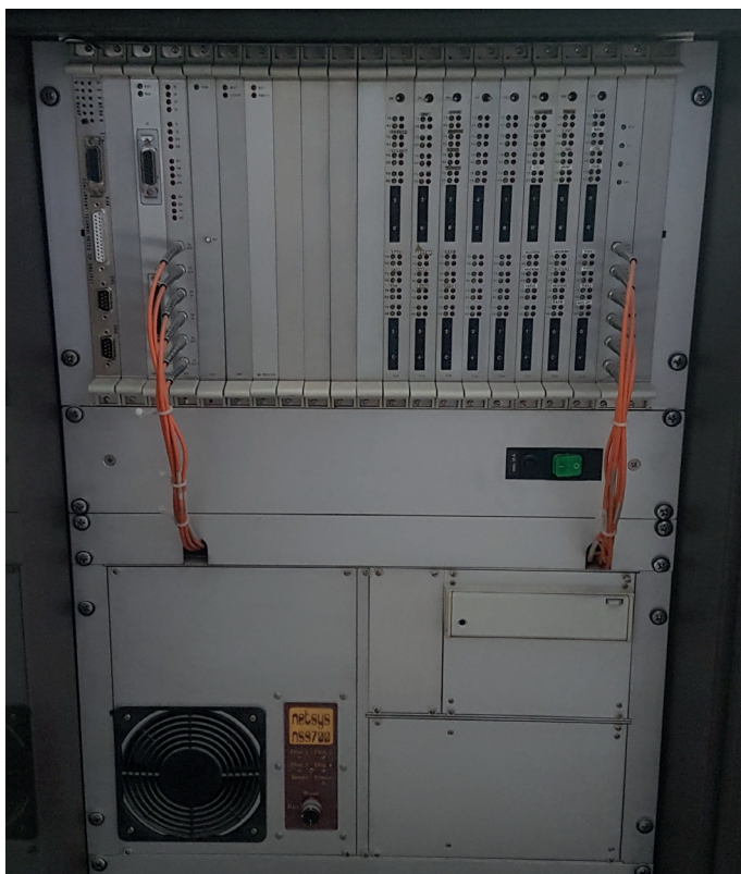
1. ábra. Az OMSZ központban működött az NS9700 típusú, duál-kiépítésű távközlési számítógép (MSS, 1993.)
